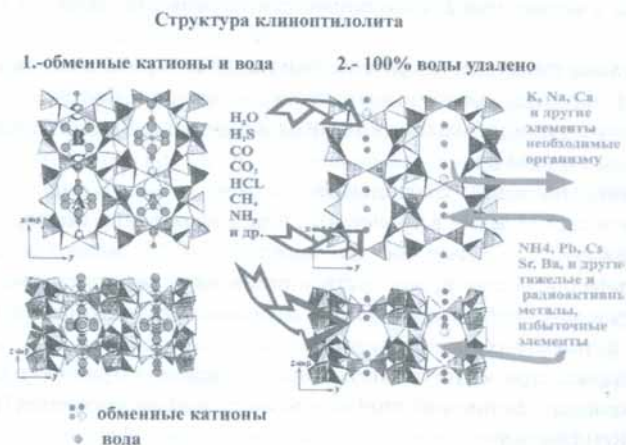
Рис. 5. Механизм реакций ионного обмена на цеолите.
